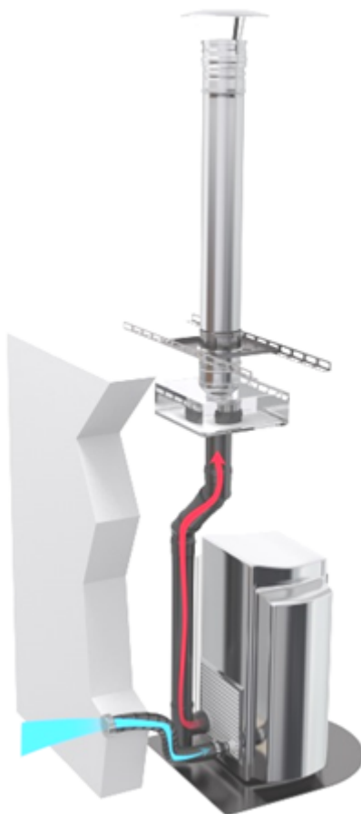
Figure 7 - Configuration séparée Raccordement simple paroi et conduit isolé en situation intérieure (poêles et chaudières à granulés)
