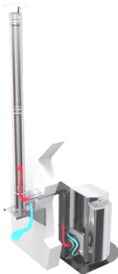
Figure 8 - Configuration séparée : Raccordement concentrique et conduit isolé en situation extérieure (poêles et chaudières à granulés)
