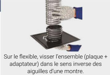
Sur le flexible, visser l'ensemble (plaque + adaptateur) dans le sens inverse des aiguilles d'une montre.
