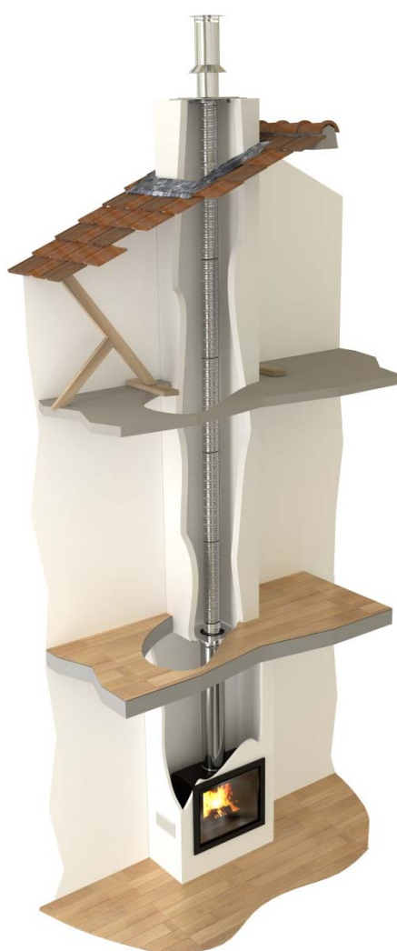
Figure 13 – Montage du système TEN Gaz C 92 (cas de l'insert)
